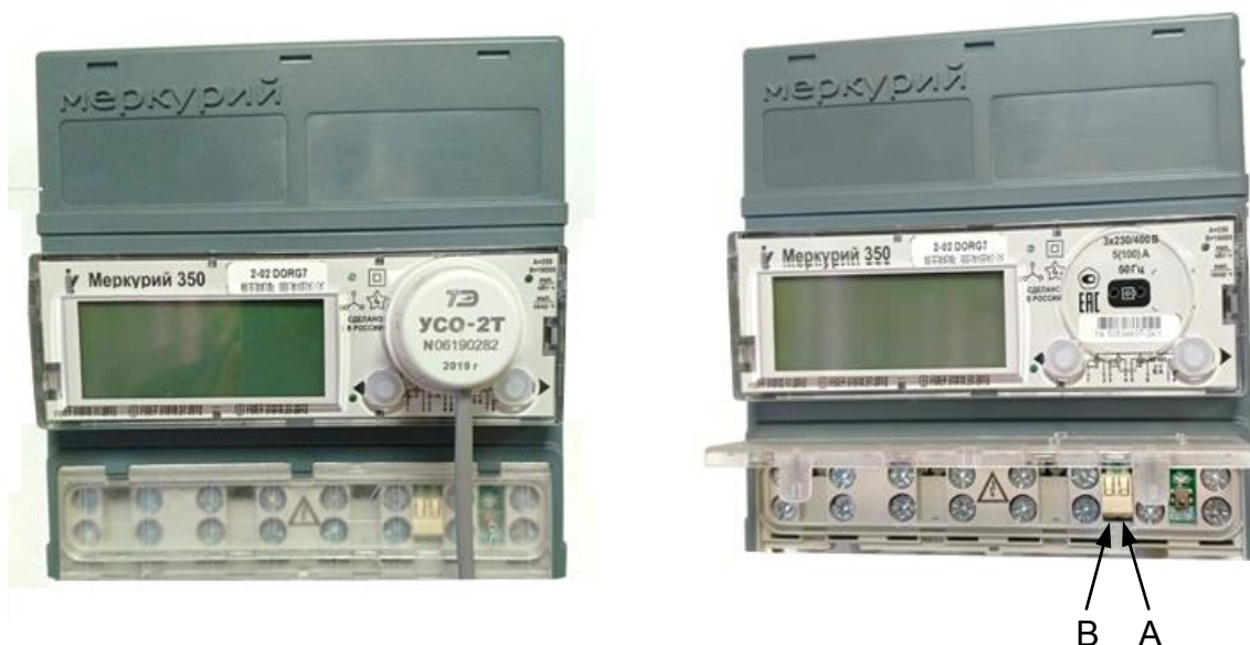
Рисунок 6.4 – Расположение оптической головки (слева) и назначение контактов для подключения интерфейса RS485 (справа)
