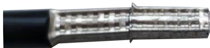
Рисунок 6.1 – Обжим провода СИП наконечниками НШВ 16-18
