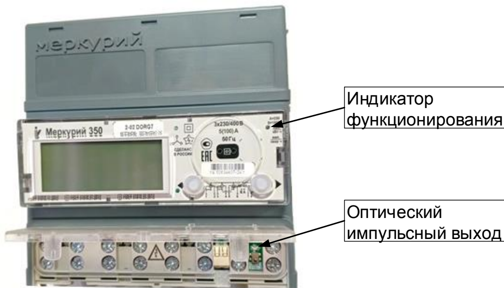
Рисунок 7.1 – Расположение оптического импульсного выхода
