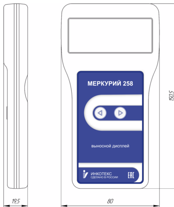
Рисунок А.5 – Габаритный чертеж выносного дисплея
