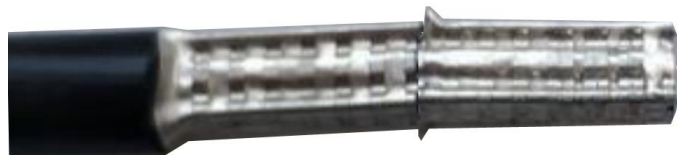
Рисунок 6.1 – Обжим провода СИП наконечниками НШВ 16-18
