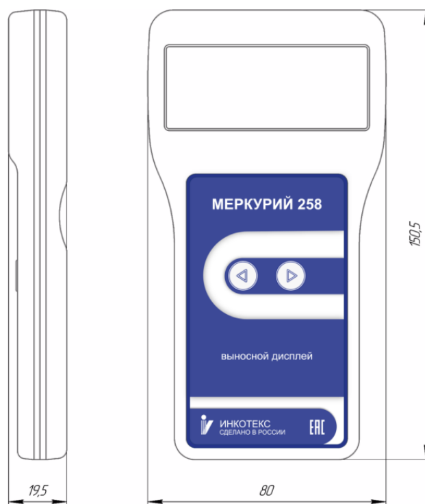
Рисунок А.3 – Габаритный чертеж выносного дисплея
