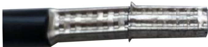
Рисунок 6.1 – Обжим провода СИП наконечниками НШВ 16-18
