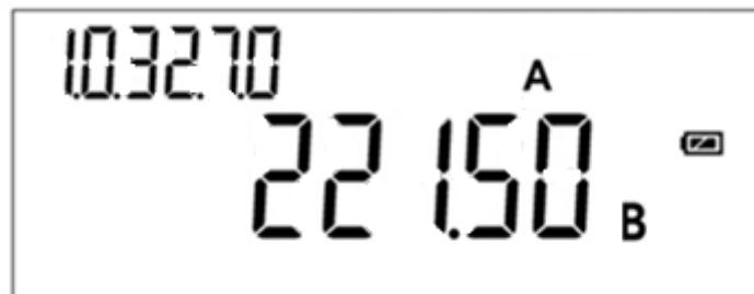
**Рисунок 6.7 – Отображение напряжения фазы А**
