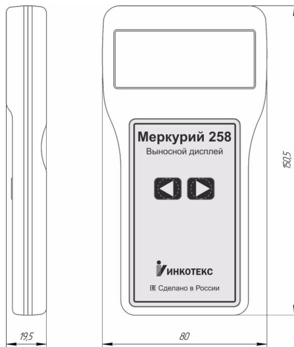
**Рисунок А.3 – Габаритный чертеж выносного дисплея**
