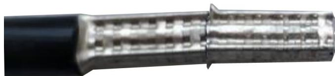
**Рисунок 6.1 – Обжим провода СИП наконечниками НШВ 16-18**
