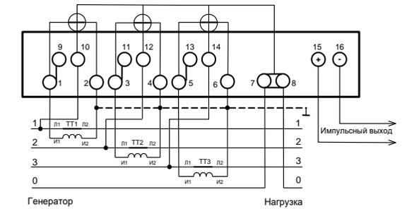
Схема подключения счётчика с помощью трёх трансформаторов тока
