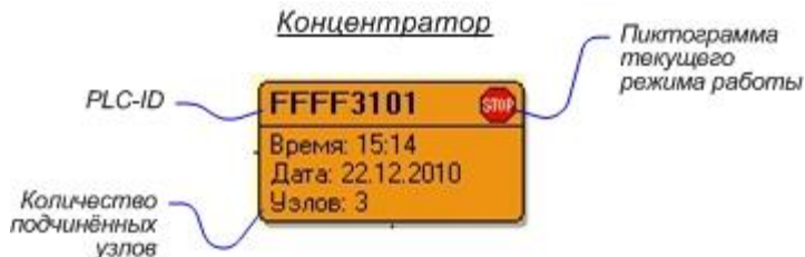
Рисунок 4.2 – NetMonitor, узел концентратор
