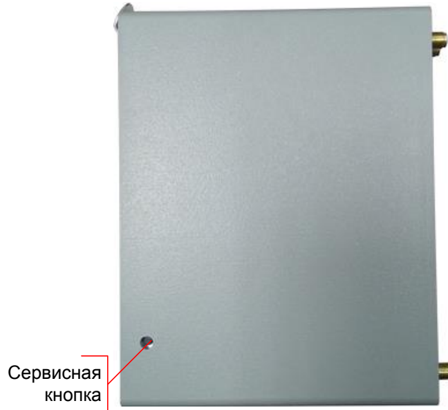
Рисунок 4.2 – Местоположение сервисной кнопки
