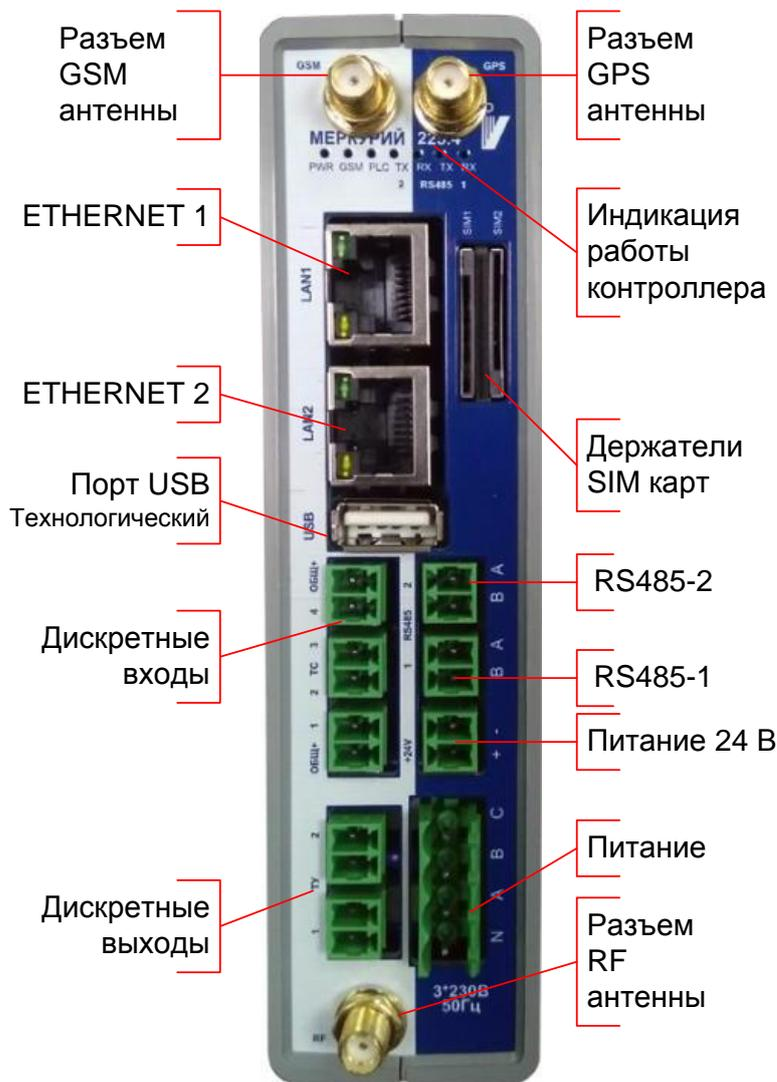
**Рисунок 1.1 – Вид панели с элементами подключения и индикации**
