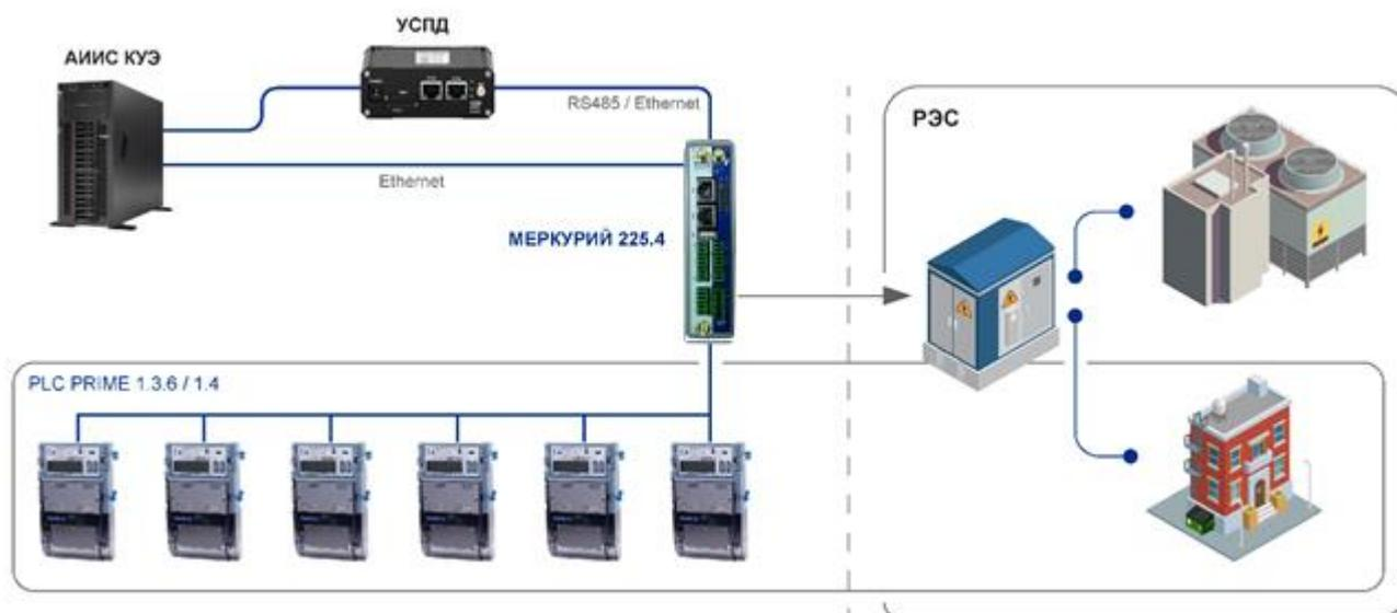
**Рисунок 1.3 – Архитектура системы с контроллером PLC PRIME**
