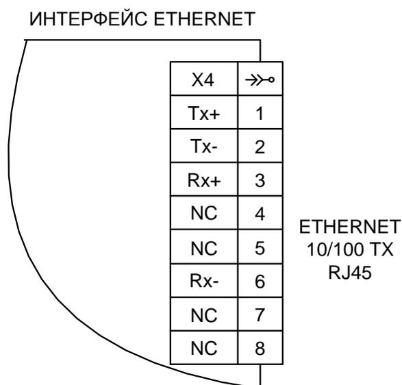
Схема подключения интерфейсов Ethernet-1, Ethernet-2.
