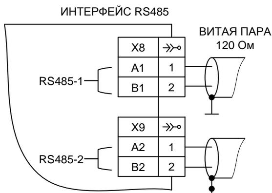
Схема подключения интерфейсов RS485-1, RS485-2.
