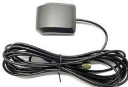
**Рисунок 2.2 –Пример ГЛОНАСС/GPS антенны**
