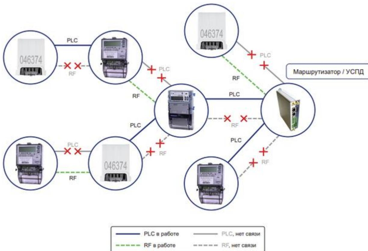
**Рисунок 1.4 – Схема работы сети G3-PLC HYBRID PLC&RF**
