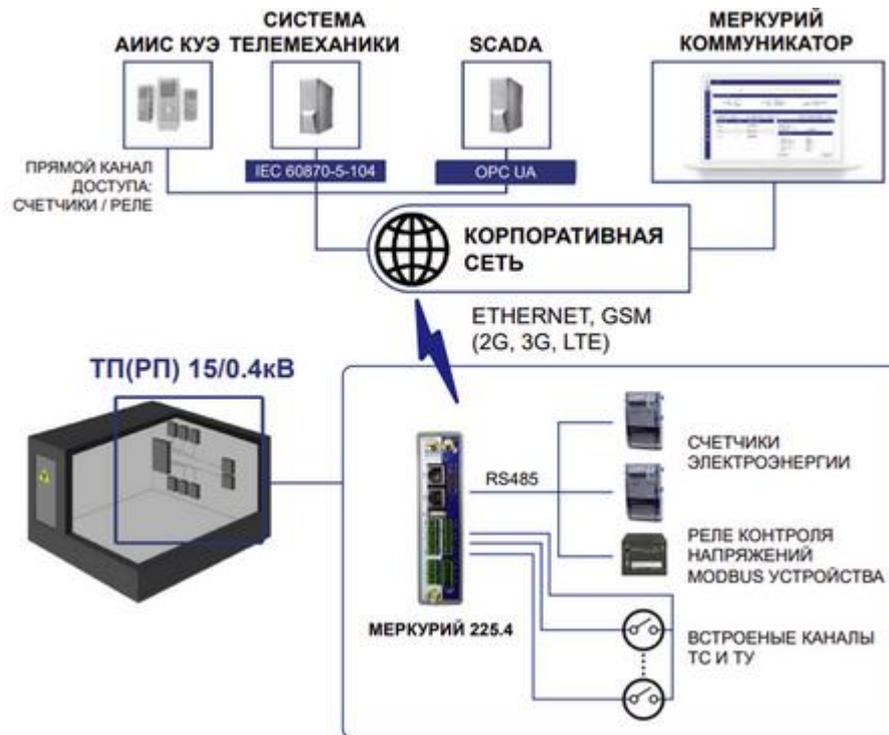
**Рисунок 1.5 – Архитектура системы с контроллером телемеханики**
