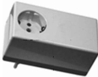
Технологический модем поддерживает связь с программируемым счётчиком по силовой сети через розетку на верхней крышке, при этом используется специальный вид модуляции сигнала, отличающийся от штатного.
