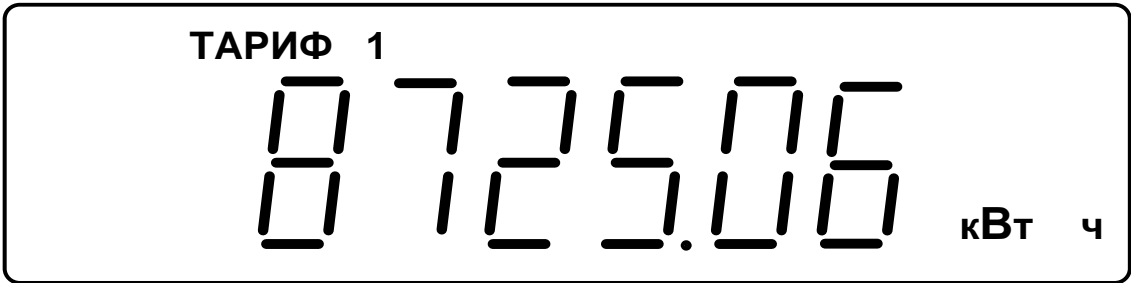
Рисунок 5.2 - Отображение активной энергии по тарифу 1
