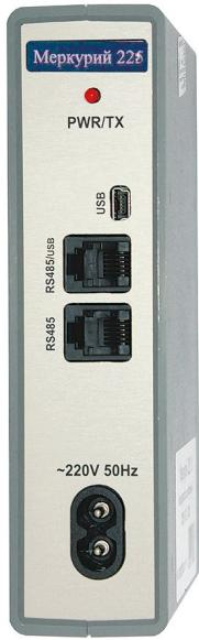
Технически концентраторы «Меркурий 225.11» и «Меркурий 225.21» являются идентичными устройствами и различаются внутренней микропрограммой, реализующей протоколы передачи данных сетей PLC-I или PLC-II.
