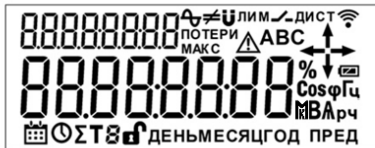
Рисунок 5.1 – Внешний вид ЖКИ выносного дисплея
