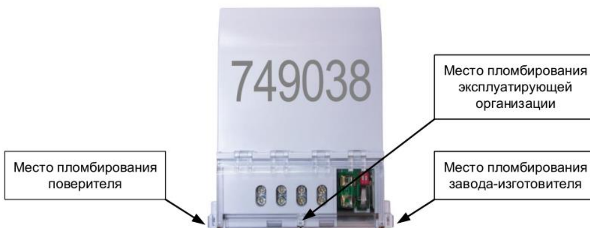
Рисунок 2.2 – Места пломбирования счетчика с индексом «X»
