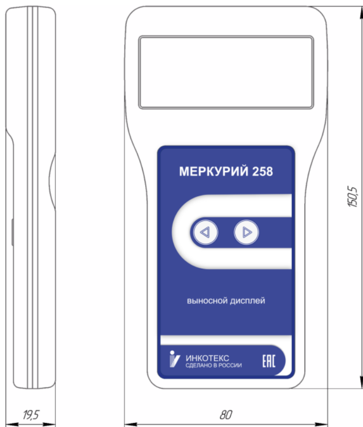
Рисунок А.2 – Габаритный чертеж выносного дисплея
