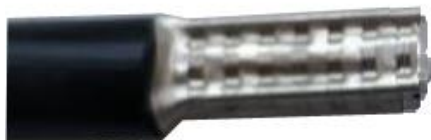
Рисунок 4.1 – Обжим провода СИП наконечником НШВ 16-18
