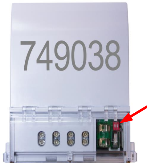
Рисунок 3.1 – Расположение переключателя блокировки управления нагрузкой
