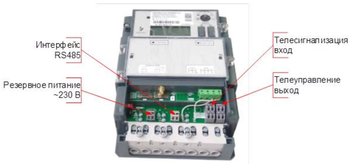
Рисунок 4.5 – Элементы подключения счетчика «Меркурий 234» с индексом «Х»
