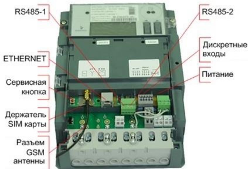
Рисунок 4.6 Элементы подключения модуля телемеханики
