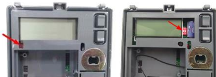
Рисунок 3.1 – Расположение переключателя блокировки управления нагрузкой счетчика «Меркурий 204»
