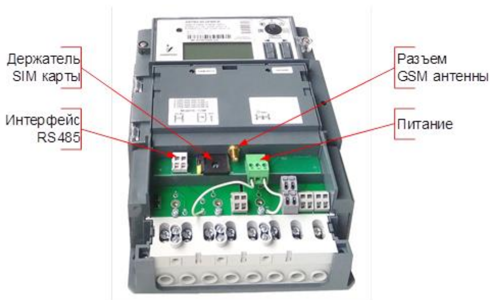
Рисунок 4.8 – Элементы подключения модуля GSM
