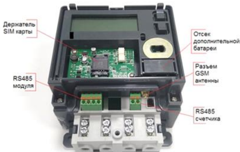
Рисунок 4.4 – Элементы подключения счетчика «Меркурий 204»
