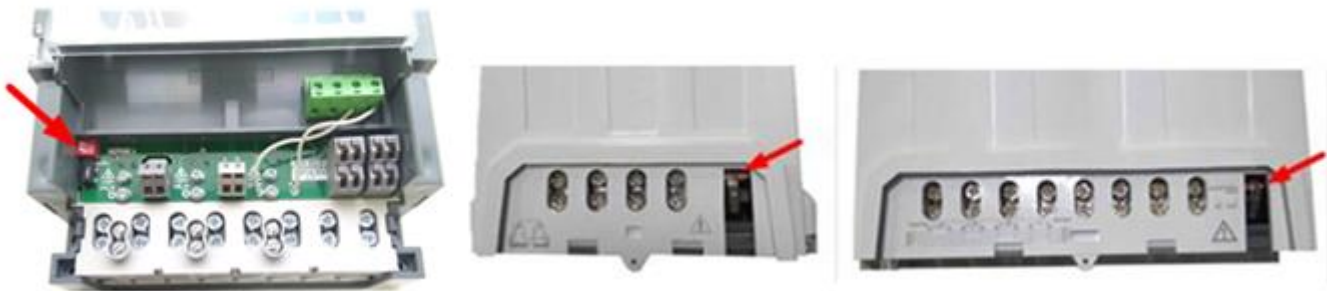
Рисунок 3.2 – Расположение переключателя блокировки управления нагрузкой счетчиков «Меркурий 234» (слева) и «Меркурий 208», «Меркурий 238» (справа)
