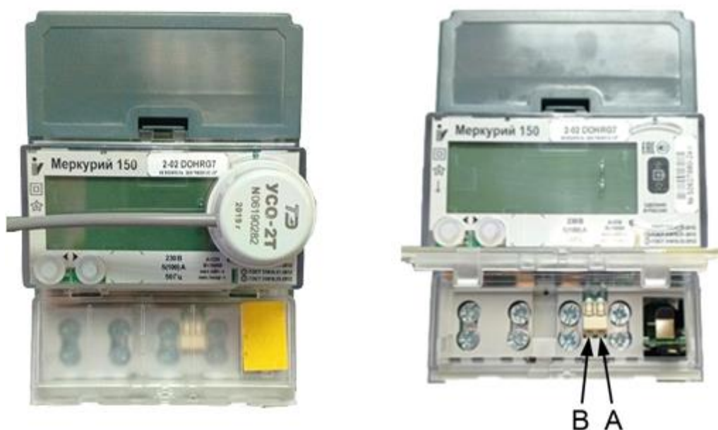
Рисунок 4.5 – Расположение оптической головки (слева) и назначение контактов для подключения интерфейса RS485 (справа)
