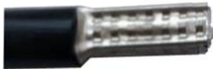
Рисунок 4.1 – Обжим провода СИП наконечником НШВ 16-18
