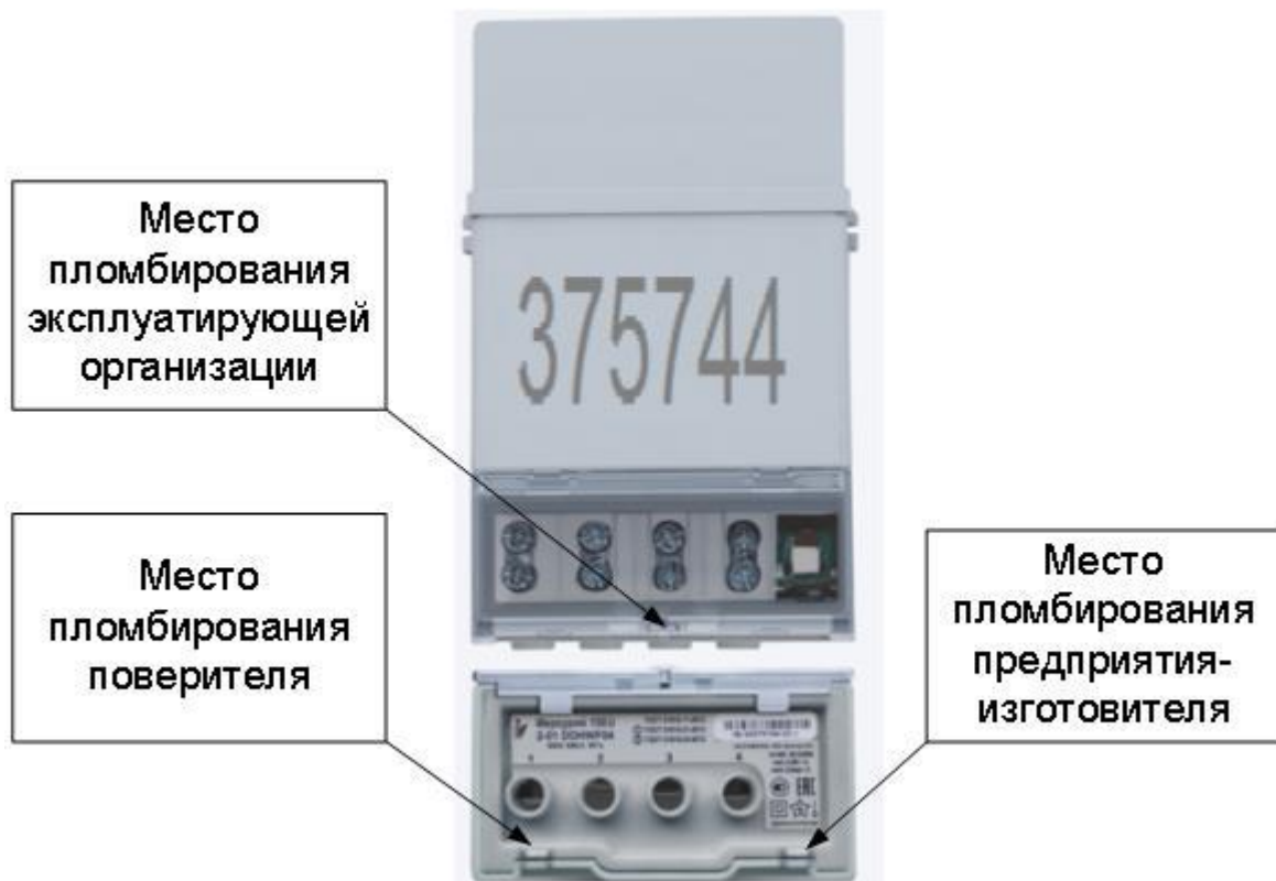
Рисунок 2.2 – Вид счетчика Меркурий 150U с указанием мест пломбирования
