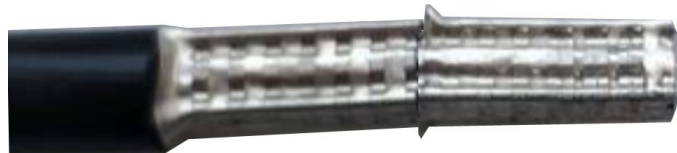
Рисунок 6.1 – Обжим провода СИП наконечниками НШВ 16-18
