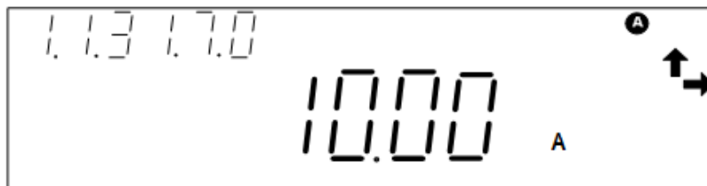
Рисунок 6.18 – Индикация действующего значения тока в каждой фазе
