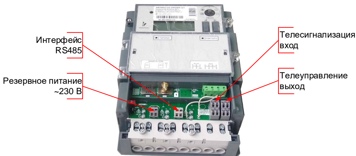
Рисунок 5.5 – Элементы подключения счетчика «Меркурий 234» с индексом «Х»
