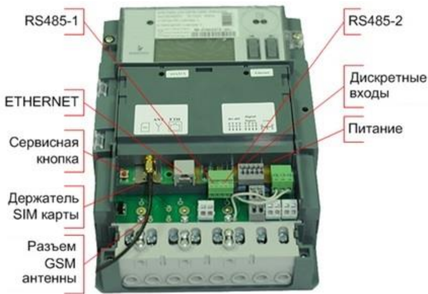
Рисунок 5.6 Элементы подключения модуля телемеханики
