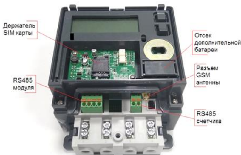
Рисунок 5.4 – Элементы подключения счетчика «Меркурий 204»
