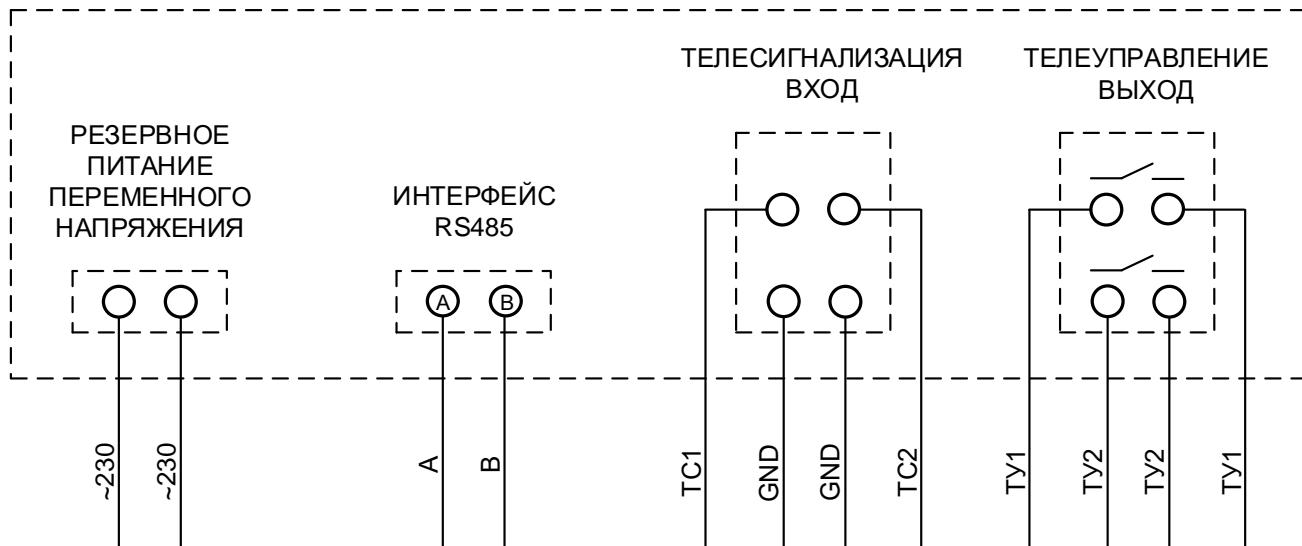
**Рисунок Б.11 – Схема подключения интерфейсов и вспомогательных цепей счетчика «Меркурий 234» с индексом «Х»**
