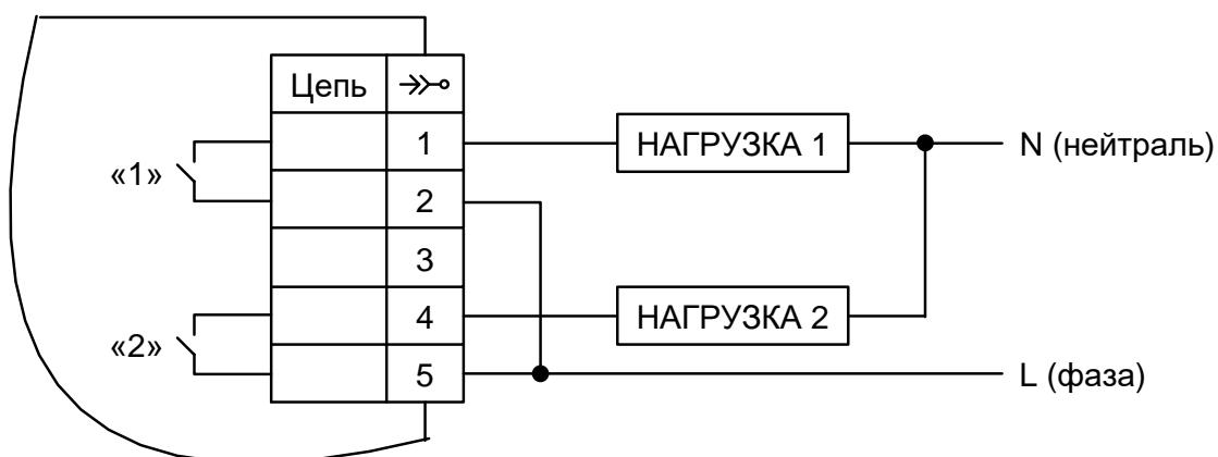
**Рисунок Б.16 – Схема подключения дискретных выходов модуля телемеханики счетчика «Меркурий 234»**
