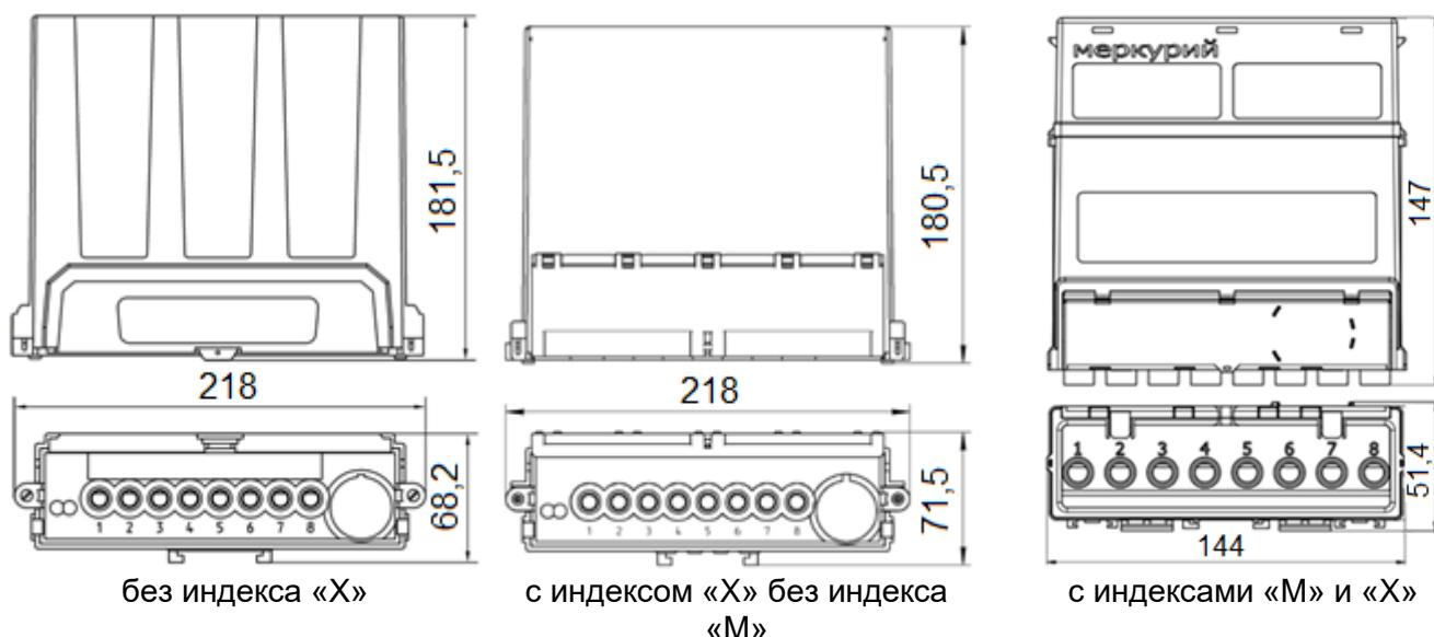
**Рисунок А.4 – Габаритные чертежи модификаций счетчика
