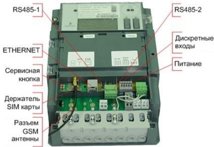
**Рисунок 5.6 Элементы подключения модуля телемеханики**
