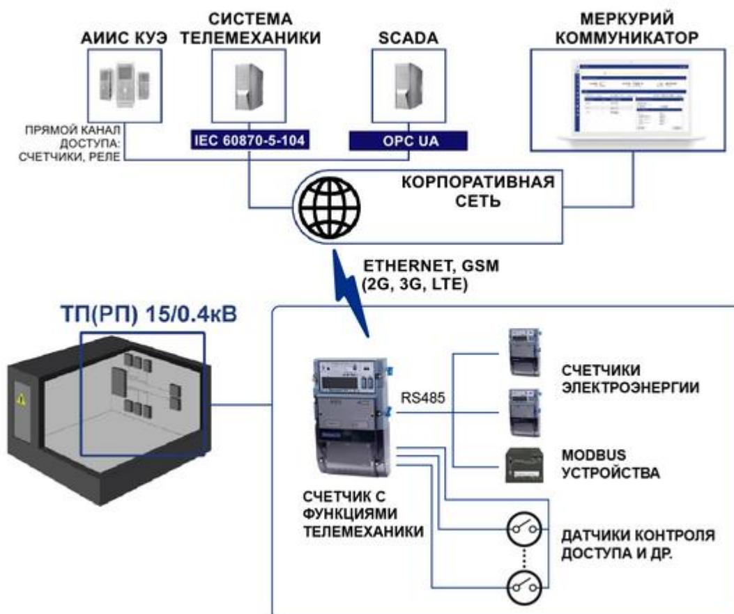
**Рисунок 4.4 – Схема работы в составе автоматизированных систем**
