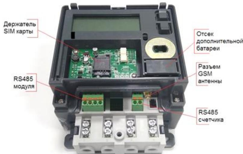
**Рисунок 5.4 – Элементы подключения счетчика «Меркурий 204»**
