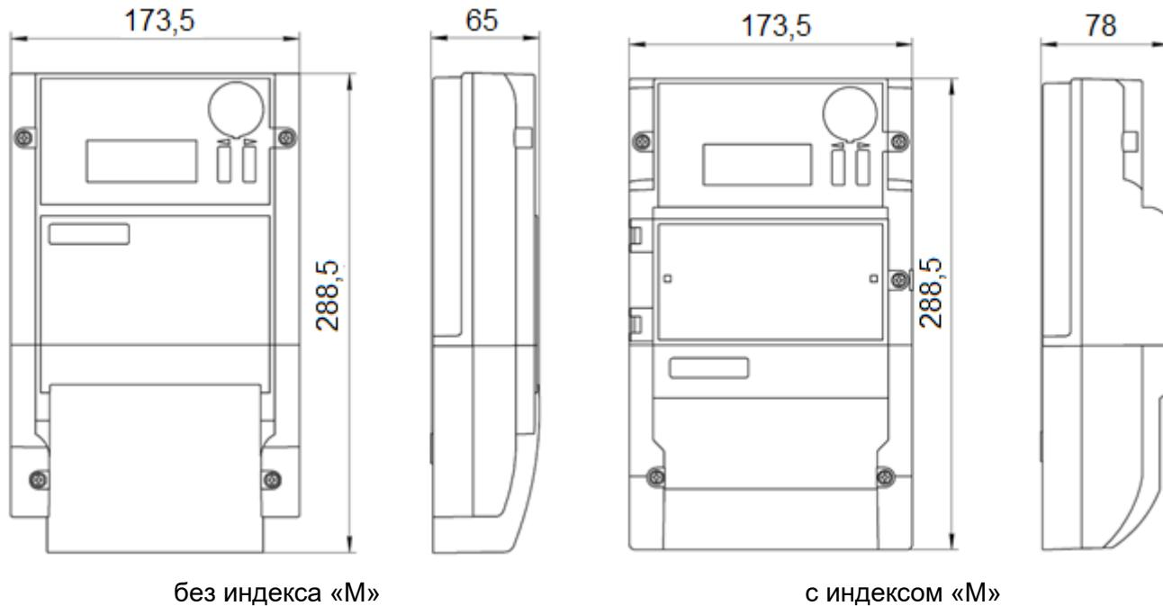
**Рисунок А.3 – Габаритные чертежи модификаций счетчика
