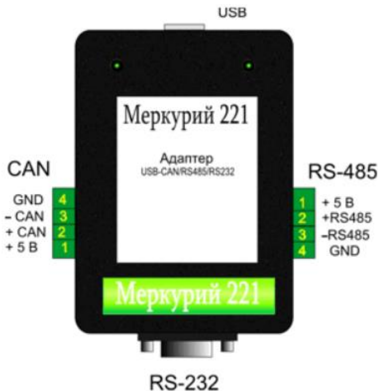
Рисунок 1.1 – Назначение клемм преобразователя
