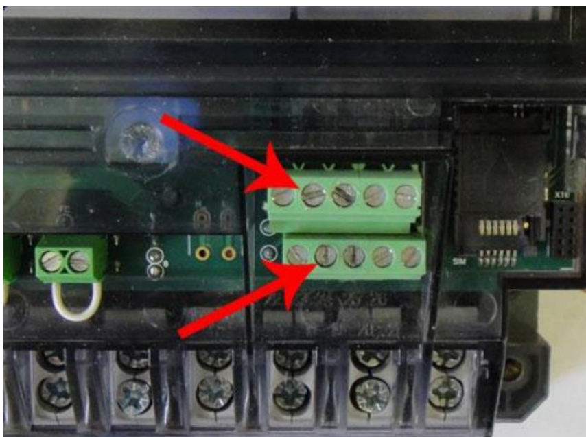
Рисунок 1.14 – Клеммы счетчика «Меркурий 230» для подачи питания интерфейса
