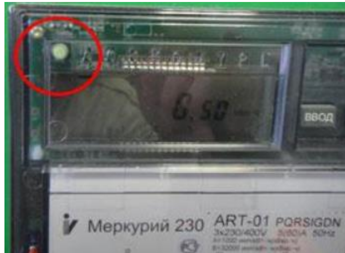
Рисунок 2.5 – Индикатор состояния встроенного GSM модема счетчика «Меркурий 230»
