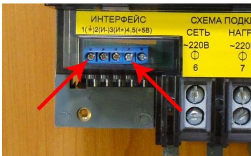
Рисунок 1.15 – Клеммы счетчика «Меркурий 200» для подачи питания интерфейса
