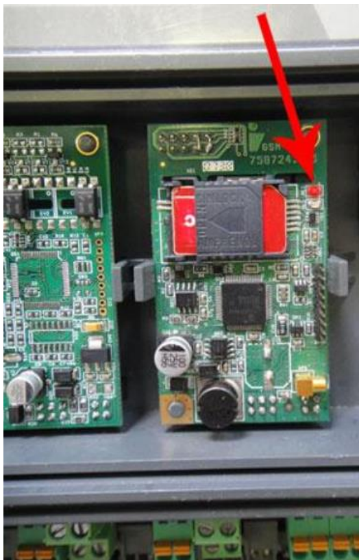
Рисунок 2.4 – Держатель для SIM-карты и индикатор состояния GSM модема счетчика «Меркурий 233»
